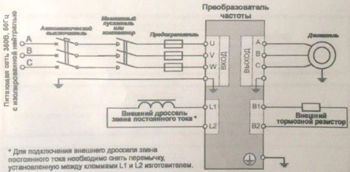
б) – подключение преобразователя в сетях с изолированной нейтралью (только для соответствующих исполнений преобразователя)
