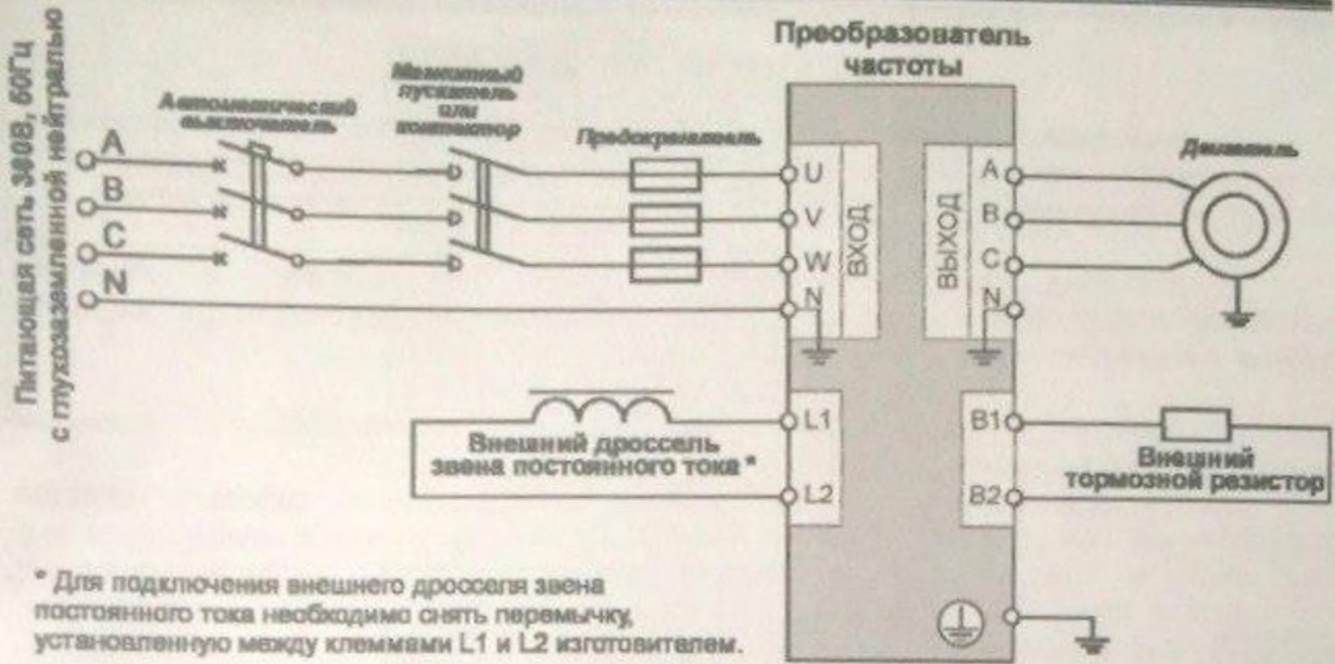
а) – подключение преобразователя в сетях с глухозаземленной нейтралью
